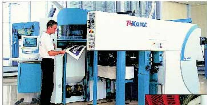
该上光装置安装在印刷机的上部,刚好位于收纸装置的前面。在完成上光操作仅5分钟之后,即可使纸张通过印刷机进行第二次印刷,并可在约60分钟之后对纸张进行切边操作,具体时间取决于油墨的饱和程度。
