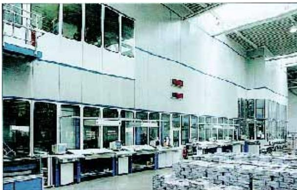
有两条纸带和加印装置的LiO的Compacta 215的配置，这可扩大可加工产品的范围
