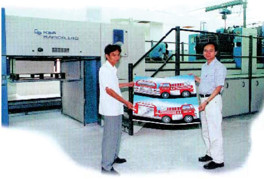
这些机器极好的先进性能适应了市场上日益增长的对更加特殊的颜色、产品的选项和可提高印品质量的联机上光的需求。自动化模块包括一个 CIPLink 接口，用于传送来自 Creo 的 CTP 印前装置的数字文件，和一个 Densitronic S 闭环墨色质量保障系统。
