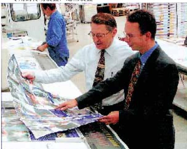
该16页印刷机的主要图片都由Karstadt,(德国的一家连锁商店)提供，是从我们正在使用的商品目录册中选出的。图片中镜像的使用可以有效地突出印刷质量的差别：左侧一页是用60线/厘米的网屏印刷的，封面则是用120线/厘米的网屏印刷的。
