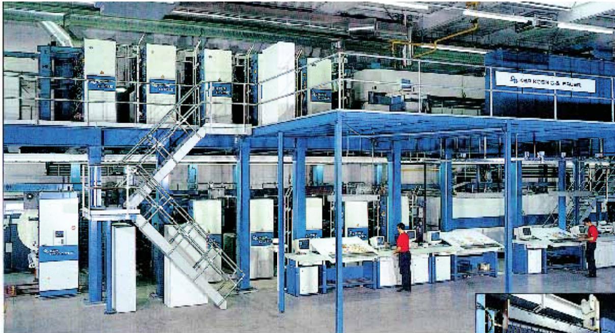
得益于单独驱动装置及其他特性，新一代商用卷筒纸胶印机（如Compacta 215）的所有印刷机组手动换版只需 10-12 分钟
