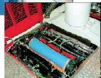
为了遵守74 Karat单人独立操作的基本理念,该机设计为只须借助一个梯子即可很容易地对上光装置进行清理和维护工作。可以提供两种形式的梯子:永久性固定的,或可拆卸并可方便地对接安装的。如果梯子是固定的,上光装置的护罩就可自动升起。如果要求提供的是移动式的梯子,那么印刷机就会装有一个可翻起的护罩,该护罩同时具有安全罩的作用。
