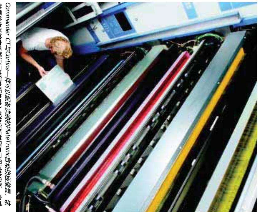
Commander CT与Cortina一样可以配备选购的PlateTronic自动换版装置，该装置使你能够在机器运行过程中预先放入新的印版并取走已用过的印版，完成换版操作只需两分钟，与印版的数量无关。
