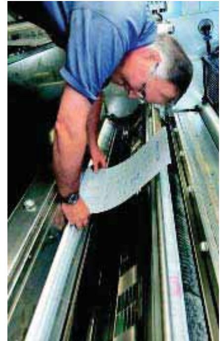
三幅宽大滚筒比双幅宽大滚筒更具成本效益的原因是：一个横向六版、轴向两版的滚筒最多安装12张印版
