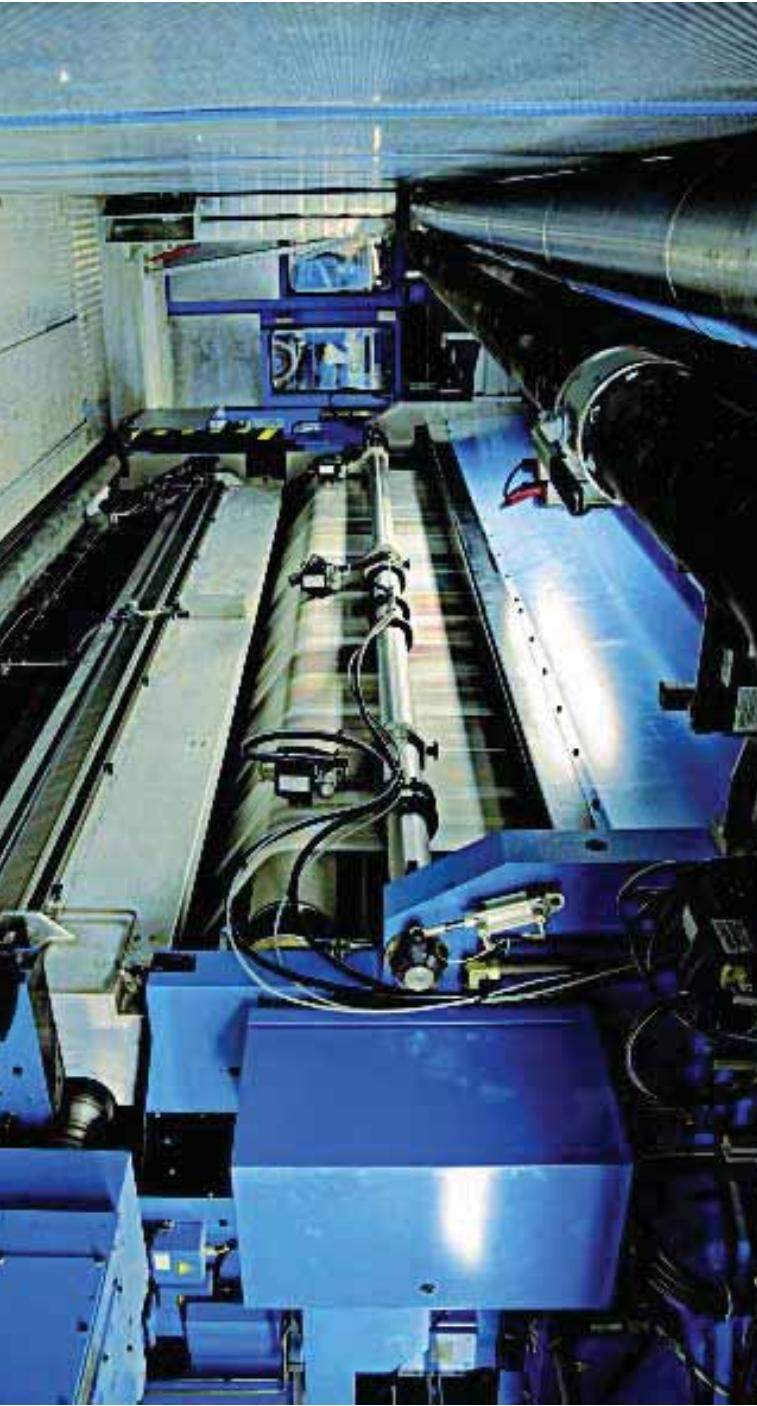
到2008年将有三台纸带宽度为4.32米(170英寸)、一台纸带宽度为2.75米(108-1/4英寸)的KBA印刷机在Prinovis Liverpool进行生产
