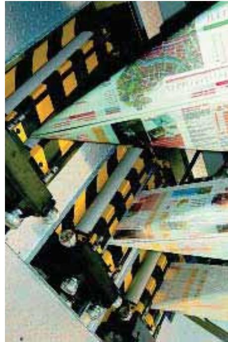
在伯尔尼的这条印刷生产线的特点是有三台滚筒比例为2:5:5的KF 5折页机
