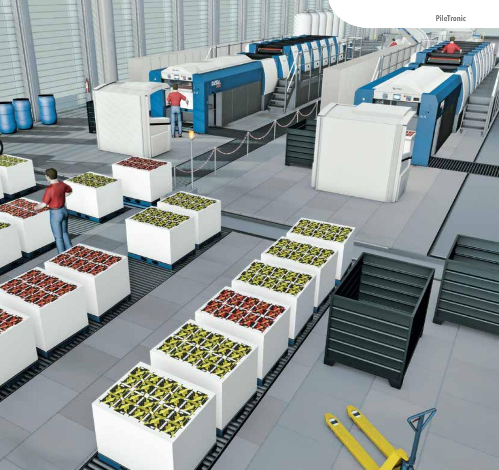
4: 一个远程控制的小车将纸堆从辊轨上取走, 并把它放到预定的位置。这个位置可以用EAN码指定。
