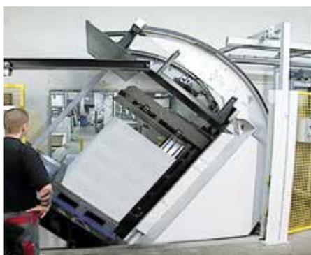
2: 全自动系统堆纸台板配发装置，用在纸堆翻转装置。
