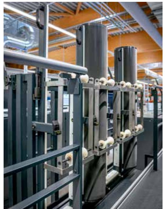
最后是干燥：VariDry系列的高性能干燥装置将在常规和UV应用中为您提供最佳的干燥效果。得益于其模块化设计，它们与印刷机的几何形状完美匹配，并且适合对中间干燥装置或最终干燥装置进行灵活使用。节能的VariDry<sup>Blue</sup>系统将对仍不饱和的干燥空气进行再循环，从而减少必需的热能输入。取决于具体活件，与常规技术相比，这有可能节省高达30%的能量！能量将会得到更加有效的利用，并且对环境的影响也将随之减小。
